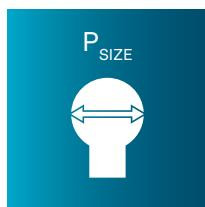
Величина  $P_{SIZE}$  представляет собой максимально допустимую погрешность при измерении диаметра сферы. Следовательно, она указывает погрешность измерений мелких деталей.
